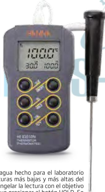
El HI93510 es un termómetro a prueba de agua hecho para el laboratorio y el campo. La pantalla LCD muestra las lecturas más bajas y más altas del ciclo junto con la temperatura actual. Para congelar la lectura con el objetivo de registrarla fácilmente, simplemente hay que presionar al botón HOLD. Se pueden elegir unidades Celsius o Fahrenheit con tan sólo tocar un botón.
