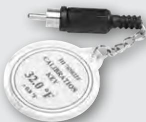
Conecte la llave a la entrada de la sonda, si la medición en pantalla es diferente por más de 0.4 °C (0.8 °F) del valor indicado en la llave, su termómetro deberá ser calibrado en nuestro centro de servicio técnico.
