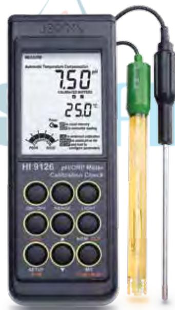
El HI9126 incluye la exclusiva tecnología CAL Check™ de HANNA, el CAL Check™ monitorea el bulbo de pH y la unión de referencia del electrodo cada vez que se calibra el equipo. En caso de que el electrodo esté sucio, el CAL Check™ informa al usuario que se necesita mantenimiento.
