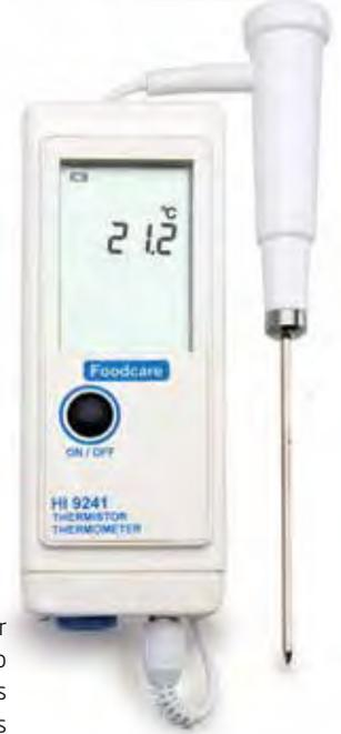
La sonda se puede intercambiar con cualquier otra de la serie HI765 sin que sea necesario recalibrar. Existe una gran diversidad de sondas HI765 y de cables de diferente longitud. Las sondas se pueden ordenar con mangos de diferente color para evitar la contaminación cruzada.
