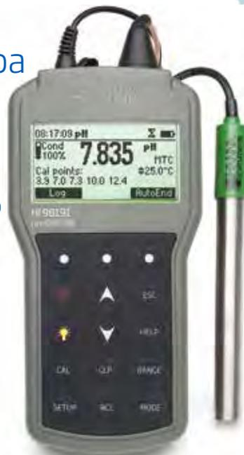
El HI98190 y el HI98191 son medidores portátiles a prueba de agua, diseñados para aplicaciones demandantes, el HI98190 mide pH/mV y temperatura mientras que el HI98191 también incluye mediciones de ISE. Ideales para uso en campo, estos medidores vienen equipados con un electrodo de pH/temperatura con cubierta de titanio.
