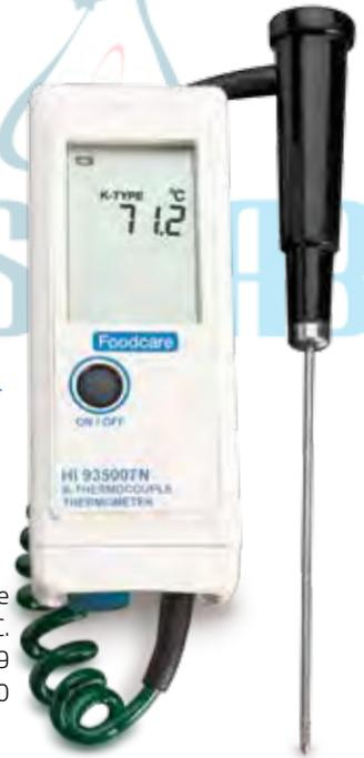
HI935007N es un termómetro portátil que mide temperaturas tan altas como 1350 °C. Tiene una resolución de 0.1 °C hasta los 199.9 °C y cambia automáticamente a 1.0 °C de 200 a 1300 °C.
