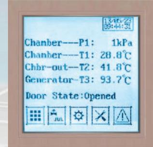
Muestra temperatura, presión, tiempo, estado de funcionamiento y más.
