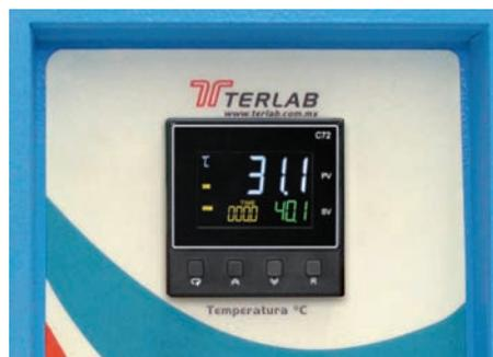
Control digital con rampas tipo P.I.D. y timer hasta 4,553 minutos.
